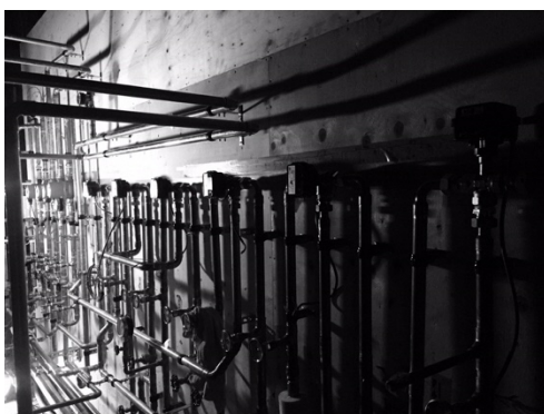
屏風岩実験装置（屏風岩の冷水を活用した保冷倉庫実験装置）
