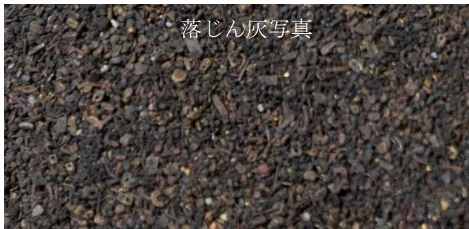
一般廃棄物を焼却した際に出る焼却灰の中で、ストーカー炉の火格子の隙間からの落下物を「落じん灰」と言います。従来は主灰と一緒にされ、コンベアで灰ピットに貯留されていました。落じん灰には、銅、亜鉛、鉛が多く含まれる他、貴金属類の含有量も金鉱石と同等以上という知見を、当グループは持っています。
