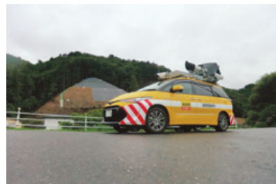
MMSによる工事現場の計測（MMSで切土法面を計測している様子）
