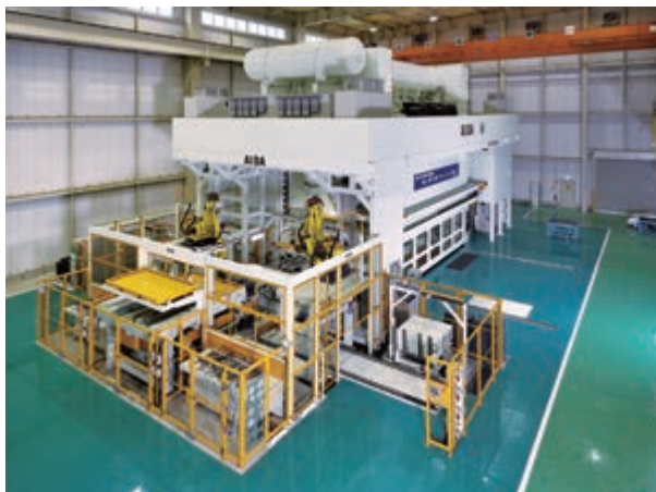
亀山製作所に導入した3,000tサーボ・トランスファー・プレス
